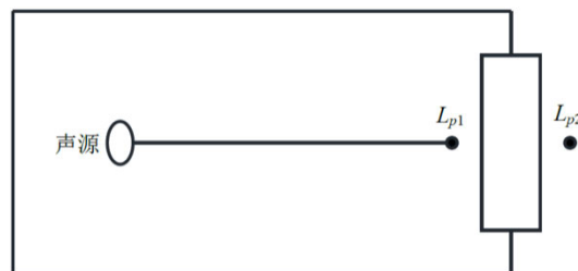
图4-4 室内声源等效为室外声源图例
