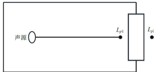
图4-4 室内声源等效为室外声源图例
