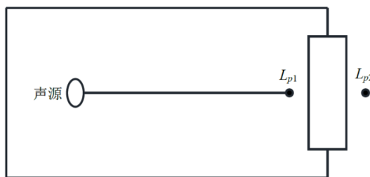
图 4-3 室内声源等效为室外声源图例
