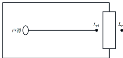
图 4-3 室内声源等效为室外声源图例
