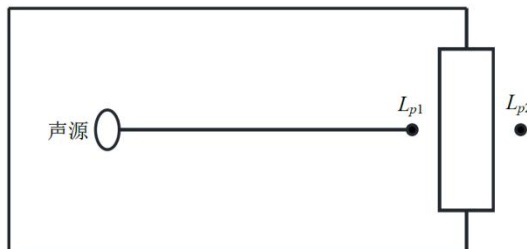
图 4-2 室内声源等效为室外声源图例
