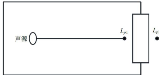
图 4-5 室内声源等效为室外声源图例
